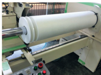
Fig.5 ロールスリッター 開反しないため、折れジワは発生しない
