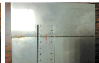
同1mm（レーザー溶接）
