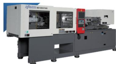
導入した電動式大型射出成形機
