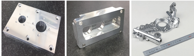
3軸と5軸の単純形状と5軸の複雑形状の加工品
