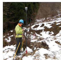
一人で測量(GPS測量)
