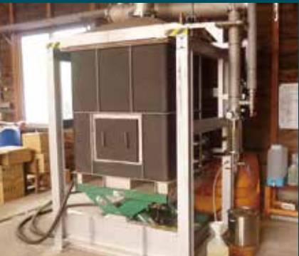
【新導入の水蒸気蒸留装置】
