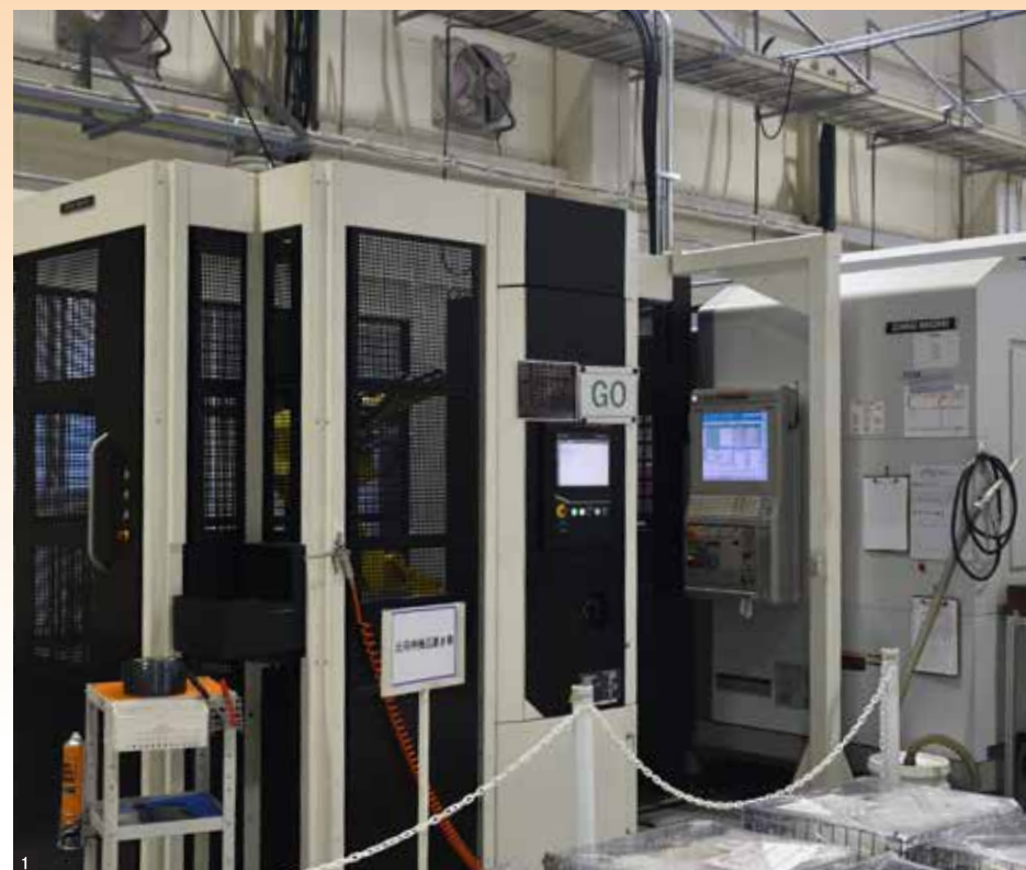
1 導入したFANUCワーク脱着ロボット 2 FANUCワーク脱着ロボット内部のアーム 3 山本金属の製品 4 山本金属の製品(2)
