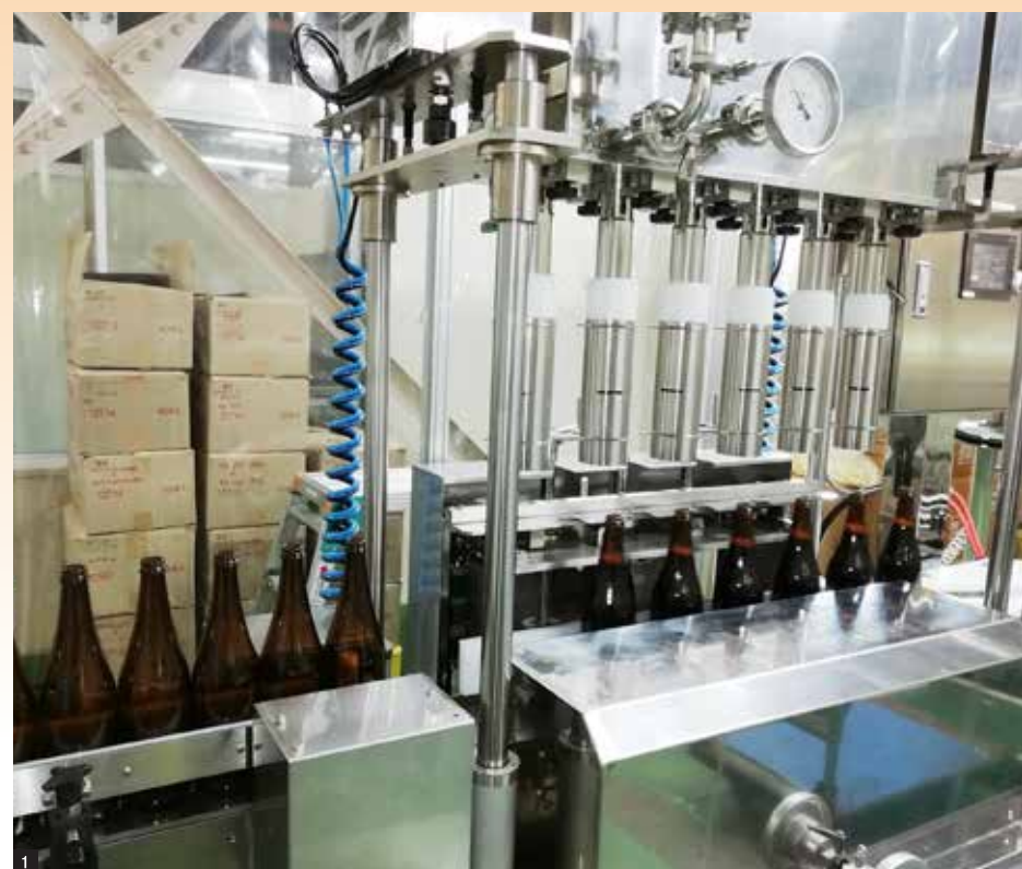
1 導入された全自動充填機
