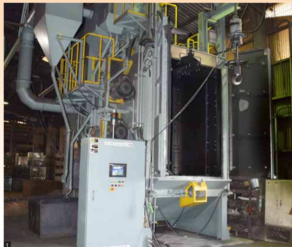
1 導入した上下ストローク付きハンガーショットブラスト 2 ヒラタ工業の製品群 3 ブラストに運ばれる部品
