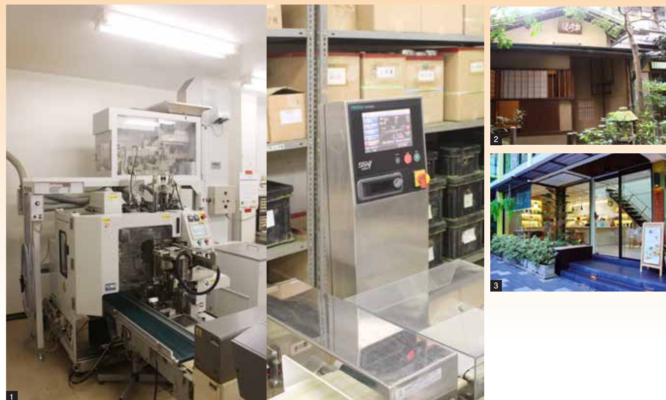
1 導入した金属検出機と小袋用全自動ガス充填包装機 2 茶室「松吟庵」 3 日本茶カフェ「Chaho」(タイ・バンコク)
