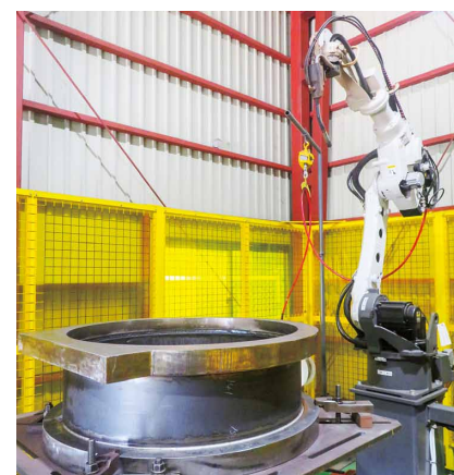
ロボット溶接システムとポジショナーで、MAG溶接を自動化
