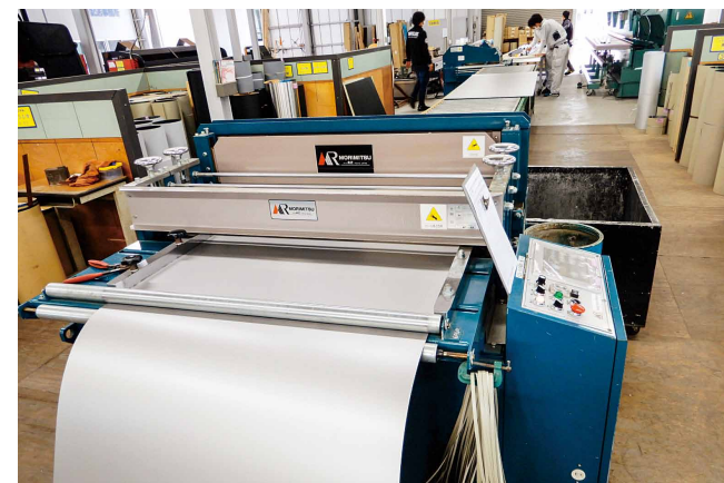
導入したガルバリウム鋼板の切断装置と折り曲げ装置
