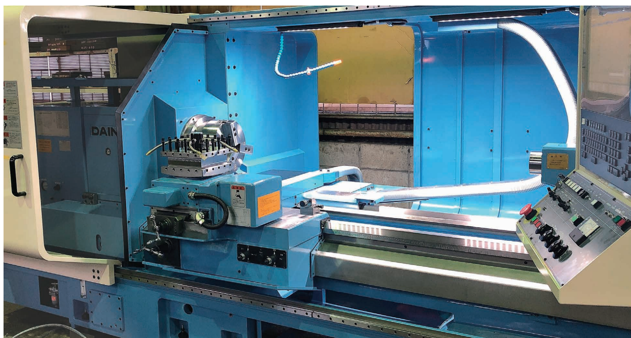
大日金属工業(株)製CNC旋盤 型式:MG65×140型 往復台上の振り:φ360mm、加工可能長:1400mm
