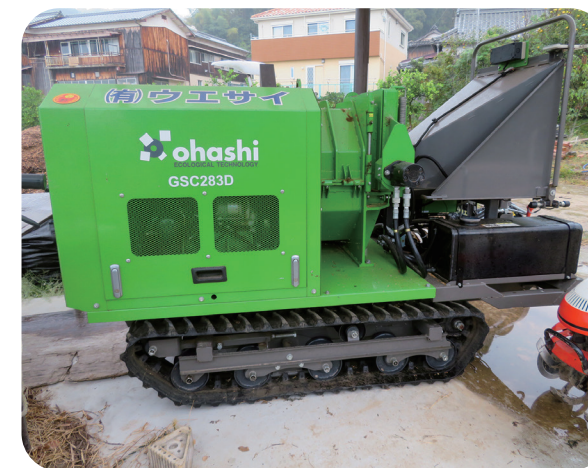
集めた伐採樹木や枝葉を樹木粉碎機でチップ加工し、肥料として再利用
