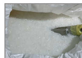
⑦定形状にカットして ペレット化
