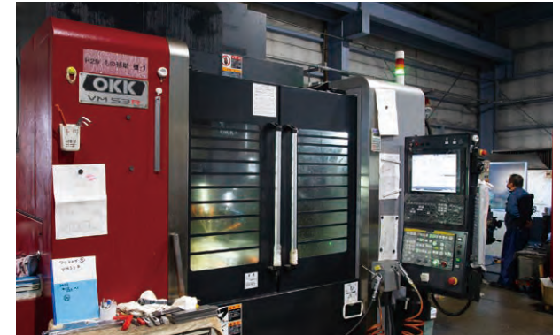
▲高精度同時5軸加工機で立体部品を製造
