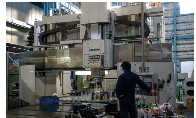
▲AI門型5面5軸加工機では大型部品を加工
