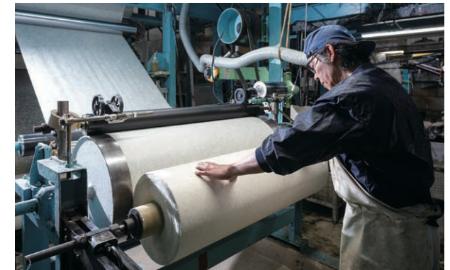
▲抄いた紙を連続的に絞り乾かし巻き取っていく、抄紙機
