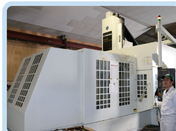
門型マシニングセンター 「高速、高精度で大型部品の加工が可能です」と後継者の中山雄一朗さん
