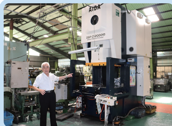
200tサーボプレス機 モーションを変えることで品質の安定した加工を実現します
