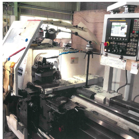
導入したNC旋盤 型式:TAC-650(滝沢鉄工所製)
