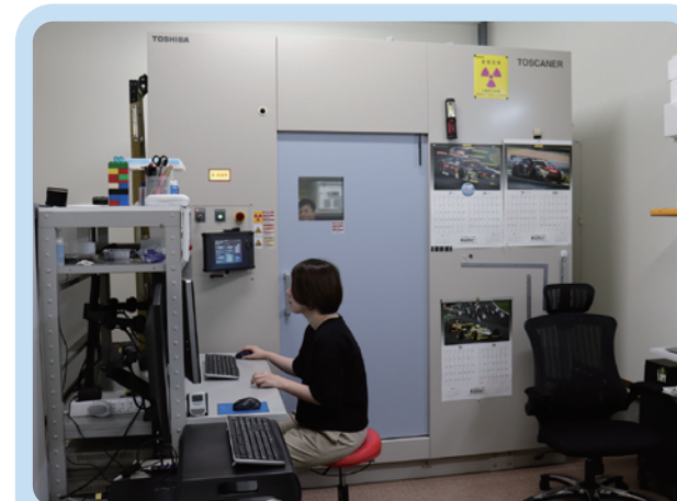
3Dモデル作成時に内部構造をスキャンするX線CTスキャナー
