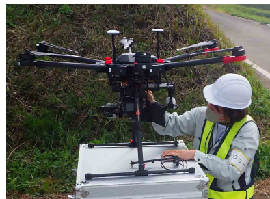
導入したUAV（無人航空機）。レーザーを装着中
