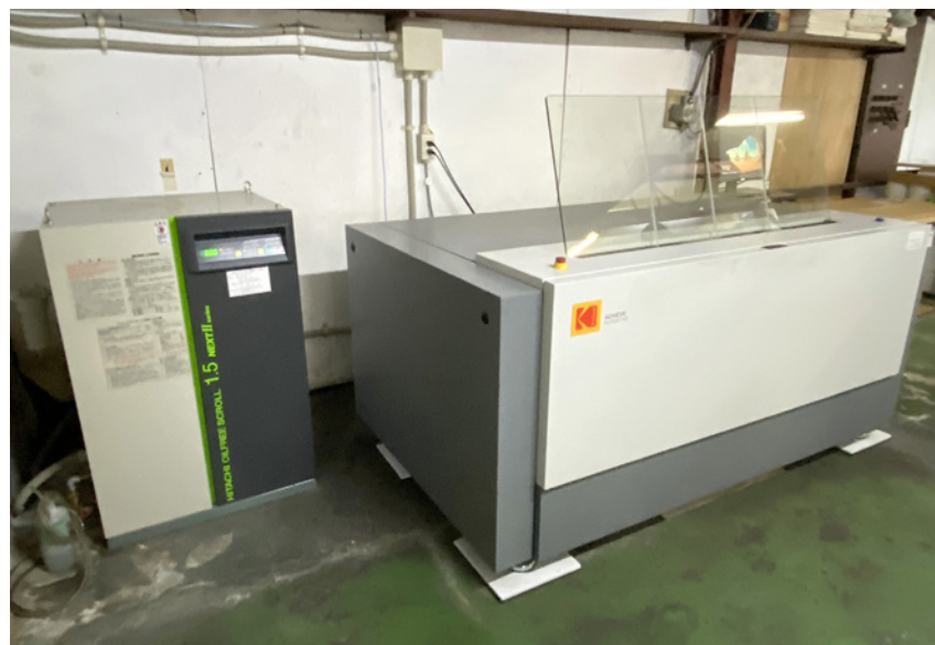
CTPプレートセッター(写真右)とコンプレッサー
