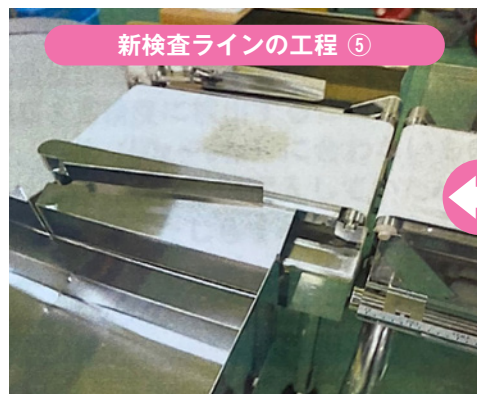
最後に「アーム式振分装置」で異物検出品を自動排除
