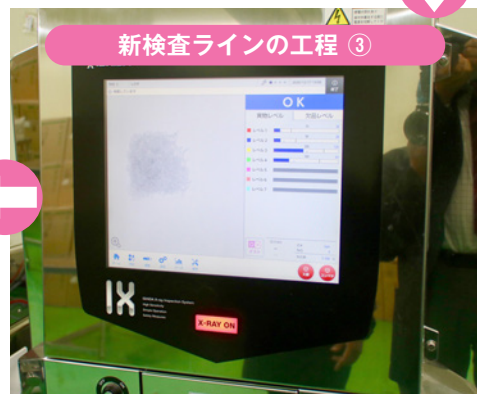
「X線検査装置」を通過するパックをデータで表示
