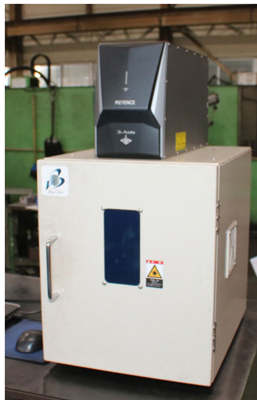
3軸同時レーザ制御システム搭載のレーザマーカ
