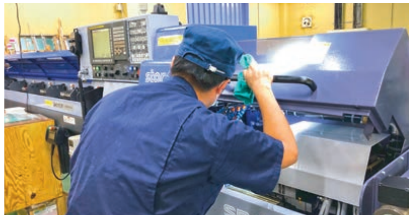
（左上）高精度CNC自動旋盤機 （右上）Φ0.3mm極小ピン加工中画像 （下）Φ0.3mm極小ピン加工風景
