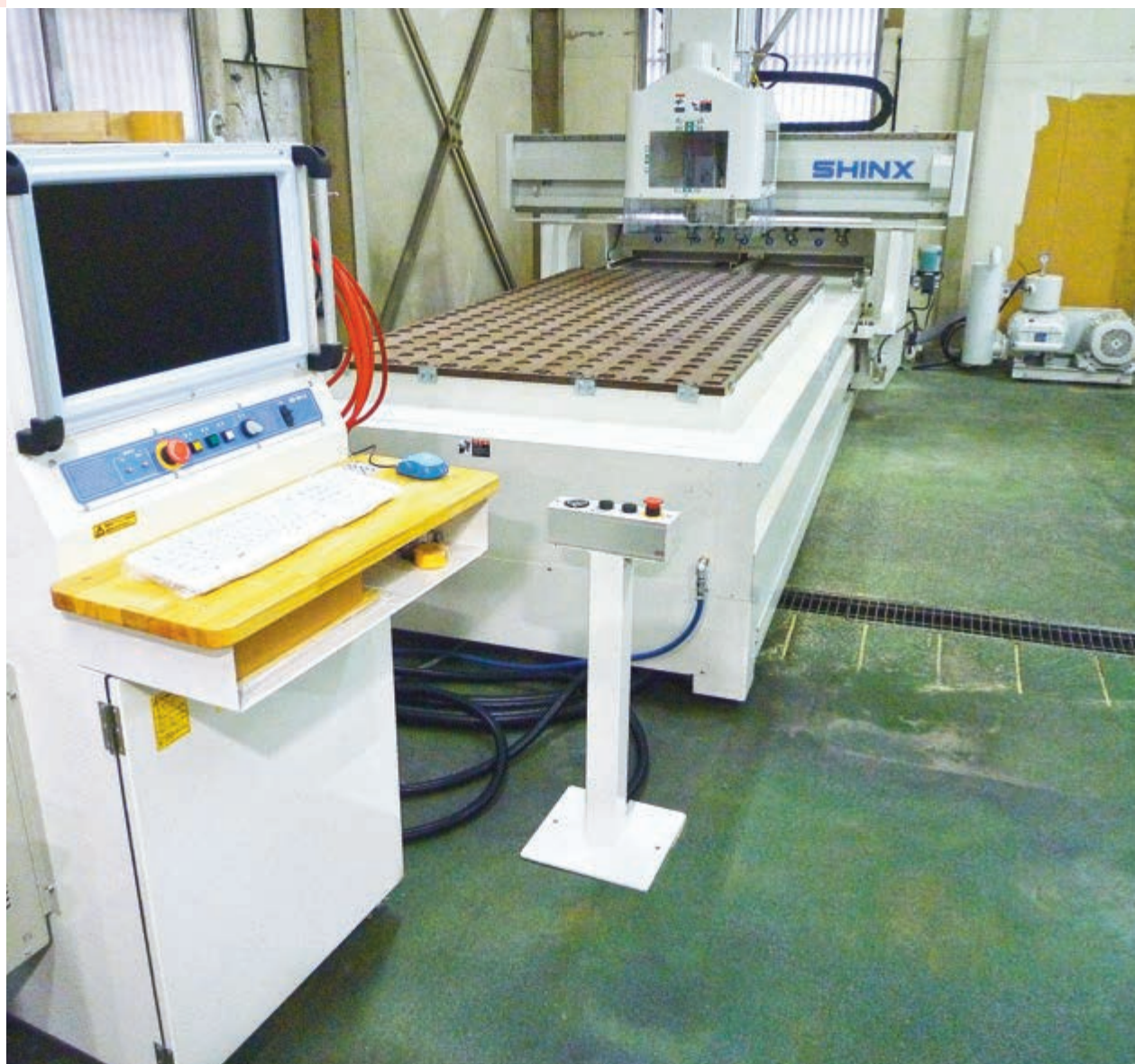
ユニバーサルヘッド5軸制御NCマシン：木口方向の穴加工、斜度切断など正確かつ安全に行える
