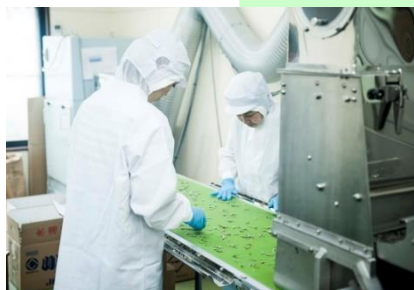
異物除去作業
