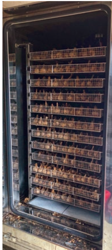
(左) 発酵から熟成までを全自動で行う新型発酵機 (右) 1度に250kg製造可能（桜島溶岩プレートによる遠赤外線効果）
