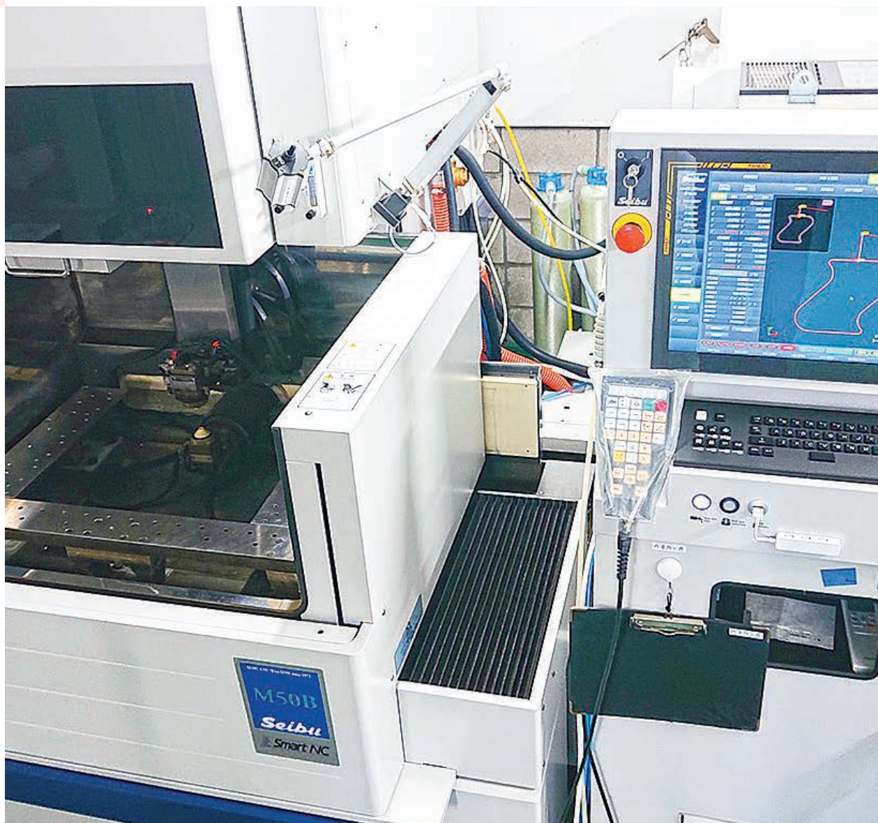
精密加工と効率化が図れる高精密ワイヤ放電加工機
