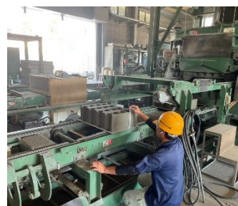
コンクリートブロックの製造
