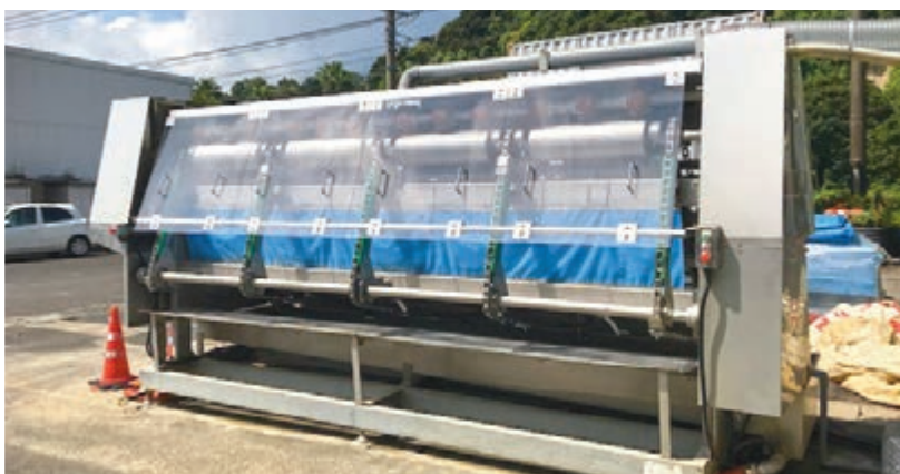
(上) 自動洗浄機による養生シートの洗浄 (下) 養生シート自動洗浄機（背面）
