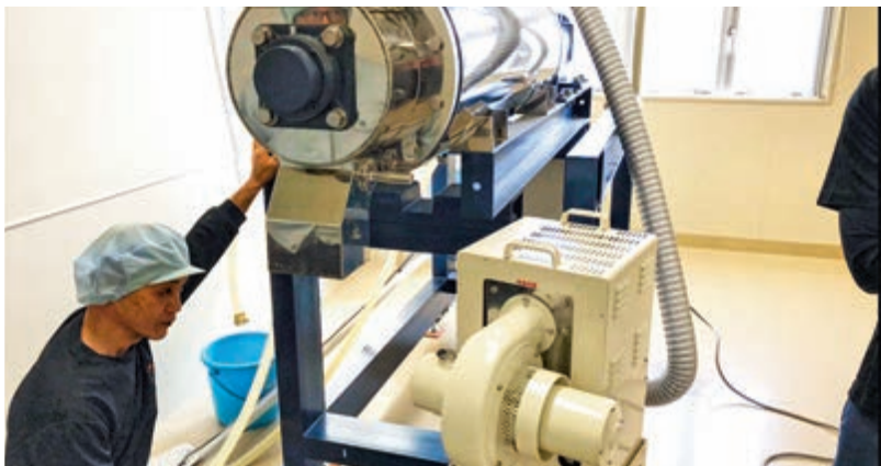
(左上) ビーズミル機の全体像 (右上) ビーズミル機による製造風景 (下) ビーズミル機内部乾燥に関する準備風景
