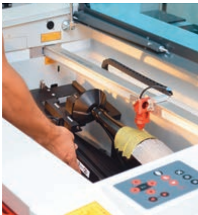
(左上) グラスやコップに彫刻したほか、カットした木材でグラスの置台も作成した (右上) 木製やゴム製の素材を彫刻・カットして製作したノベルティグッズ (左下) レーザー彫刻機に焼酎ピンをセットし、照射地点を確認する (右下) レーザー彫刻機と付属の集塵脱臭機
