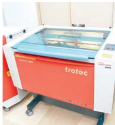
(左上) グラスやコップに彫刻したほか、カットした木材でグラスの置台も作成した (右上) 木製やゴム製の素材を彫刻・カットして製作したノベルティグッズ (左下) レーザー彫刻機に焼酎ピンをセットし、照射地点を確認する (右下) レーザー彫刻機と付属の集塵脱臭機
