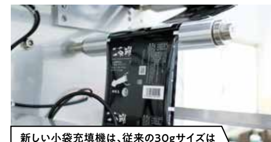
新しい小袋充填機は、従来の30gサイズはもちろん100gサイズまで充填が可能だ
