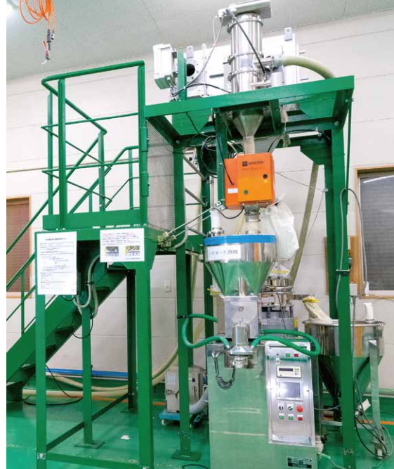
空気輸送で海藻パウダーを吸い上げ、 ふるいにかけてバック詰めする
