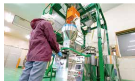
空気輸送で海藻パウダーを吸い上げ、 ふるいにかけてバック詰めする
