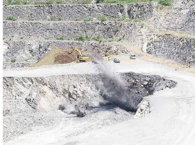
発破をかけて石を採掘する現場
