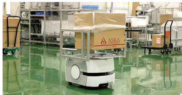
無人搬送車での包装品搬送により工場の夜間無人化生産が可能に
