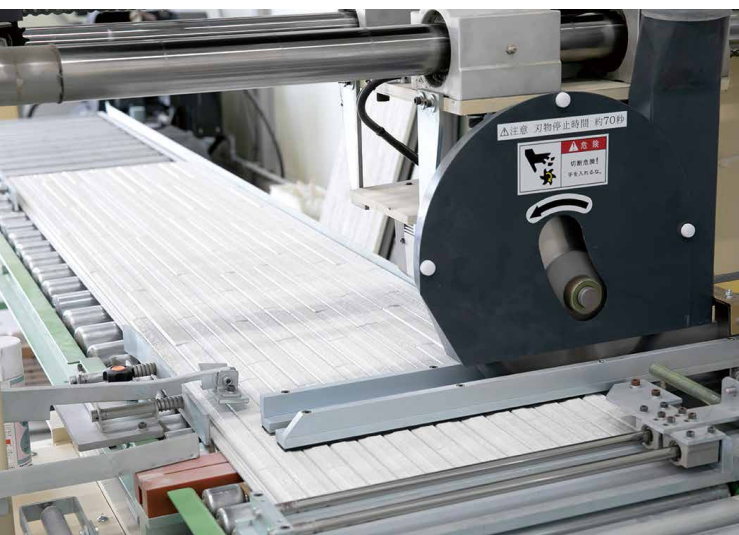
搬入された端材を必要な幅にカットする
