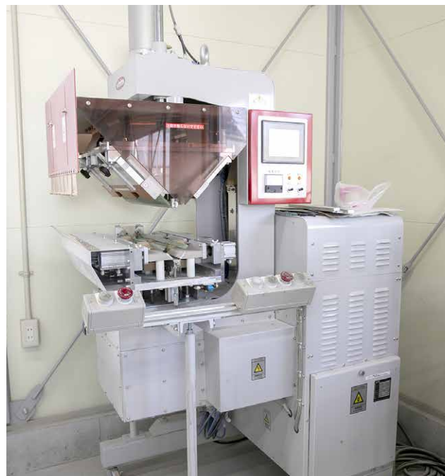
加工の肝になる高周波接着機。強度を出せる数値が入力されている
