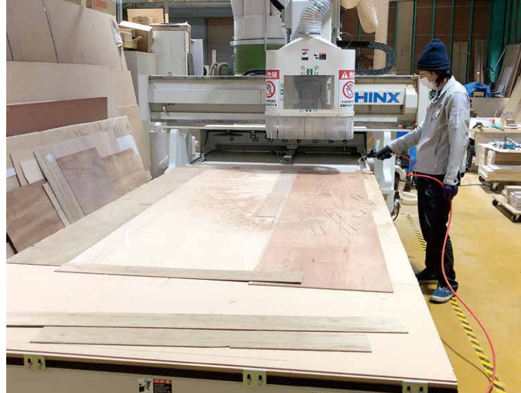
入力された図面データからパーツを裁断する
