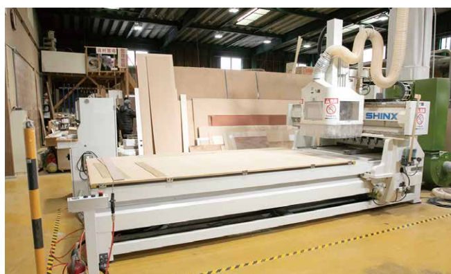
3次元的な裁断により自由な表現を実現するNCルーター
