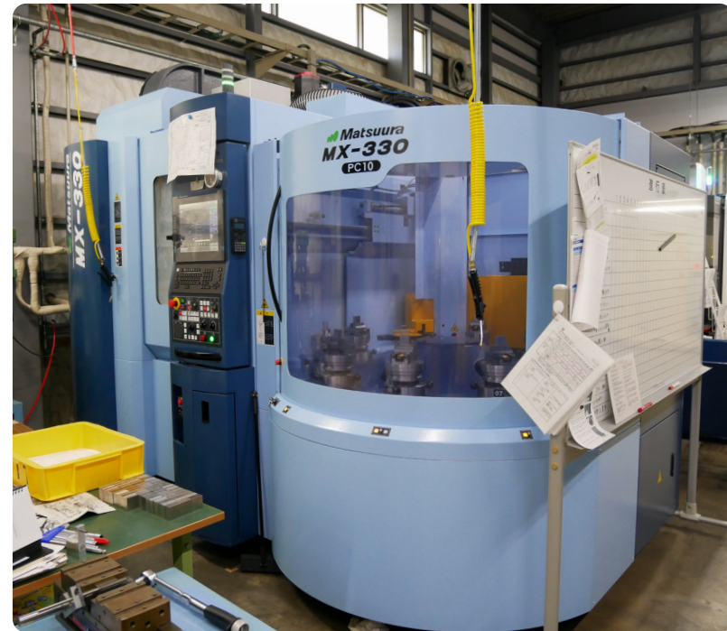
導入した5軸制御立型マシニングセンタ
