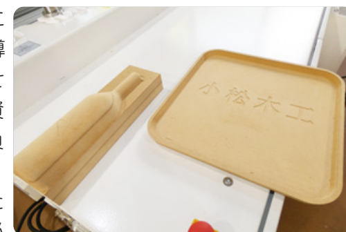
3D-NC木工用ルーターでカットした木工品の例
