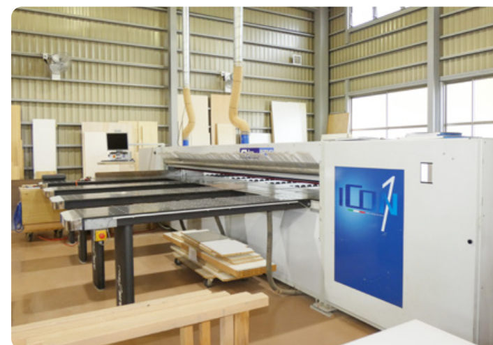
大型部材の切断が可能な横型パネルソー(最大幅4,500mm対応)
