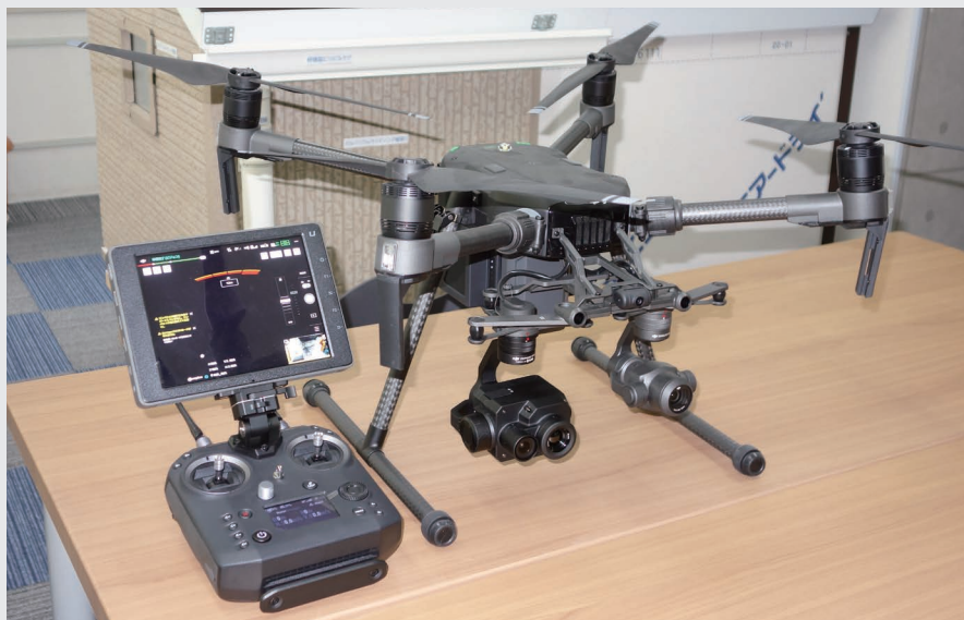
◀ドローン（赤外線カメラ搭載）。 高所や人が近づけない箇所の 調査、診断に活用。
