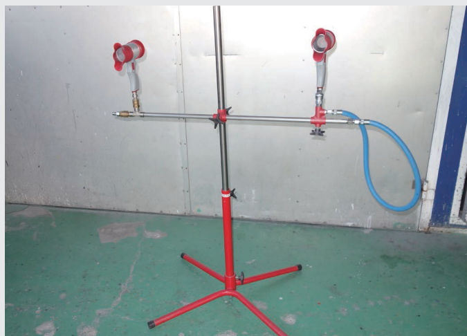
▲塗装乾燥用送風機。拡散した風を塗装面に広げ、短時間で乾燥を促す。
