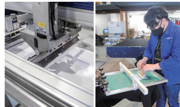
（写真左）自動スクリーン印刷機での自動プリントは何千枚でも同じ圧力でプリントできる（写真右）手動プリントは作業者によってインクの厚みも異なり大量印刷には不向き
