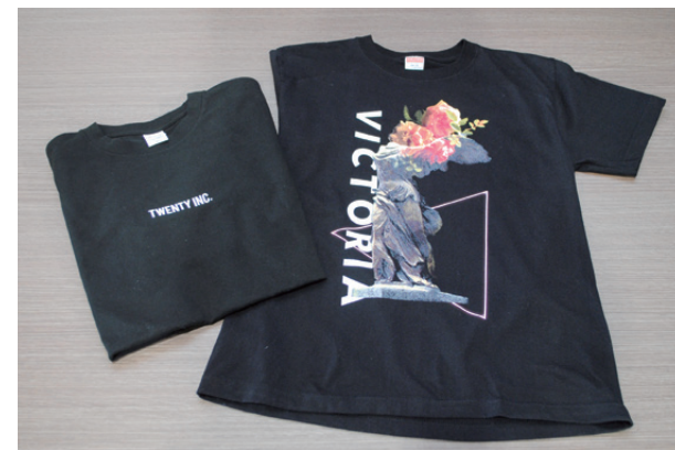
（写真左）手作業による単色刷りプリント（写真右）自動印刷機で製作した多色刷りTシャツは複雑なグラデーションも可能
