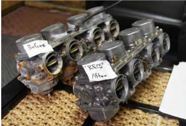
さびて汚れたキャブレター(左)と、RECSで洗浄後のキャブレター
