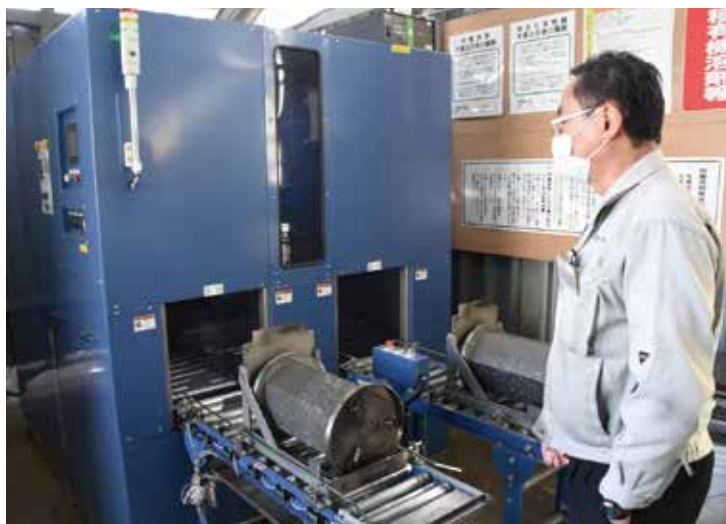
密閉式で全自動洗浄ができる新型機。手前左の洗浄かごに入れた部品が左の入り口から入り、洗浄後は右側から出てくる
