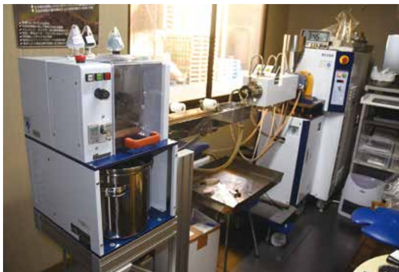
効率的なリサイクル試験を可能にしたラボプラストミル
