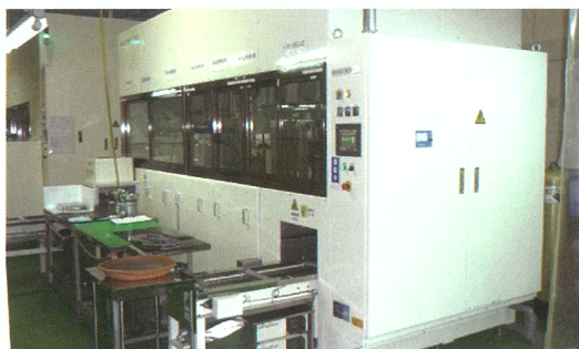
▲補助事業による設備拡充 純水全自動式超音波洗浄機
