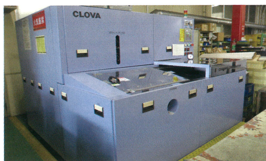
▲全自動洗浄機外観
