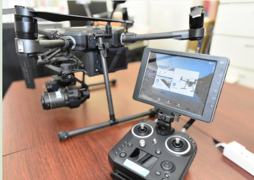
導入した赤外線カメラを搭載したドローン
